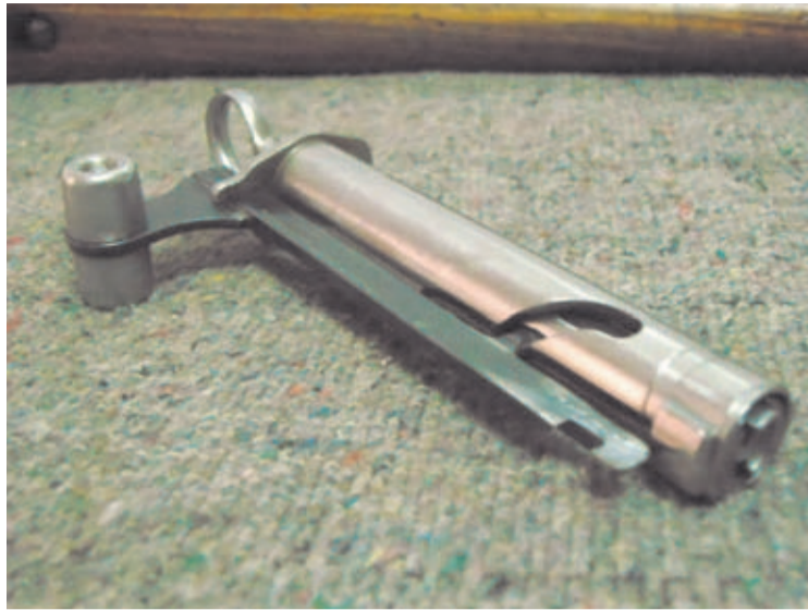
Detalle del cerrojo de acción lineal del rifle suizo Schmidt-Rubin.
