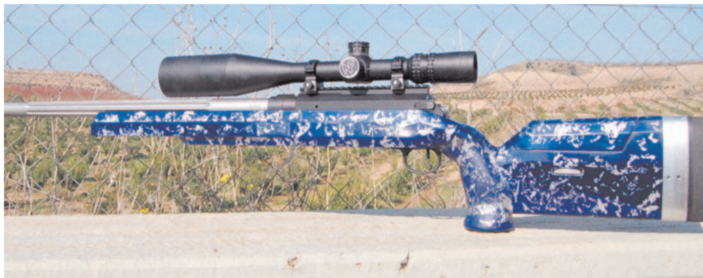
Estos fusiles se elaboran con piezas y componentes de diversos fabricantes. En este caso, este rifle está equipado con una llamativa culata Robertson Composites, la acción del Unique-FMR RS1, un cañón Krieger, un disparador Timney de 100 gramos y un visor táctico Nightforce NXS.
