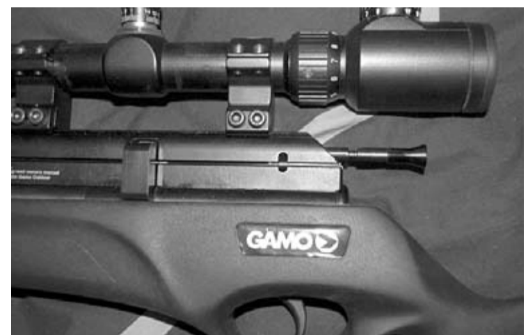
Esta carabina cuenta con el sistema de armado MMC. En esta imagen vemos el primer paso de este proceso: abrir el empujador del balín.
