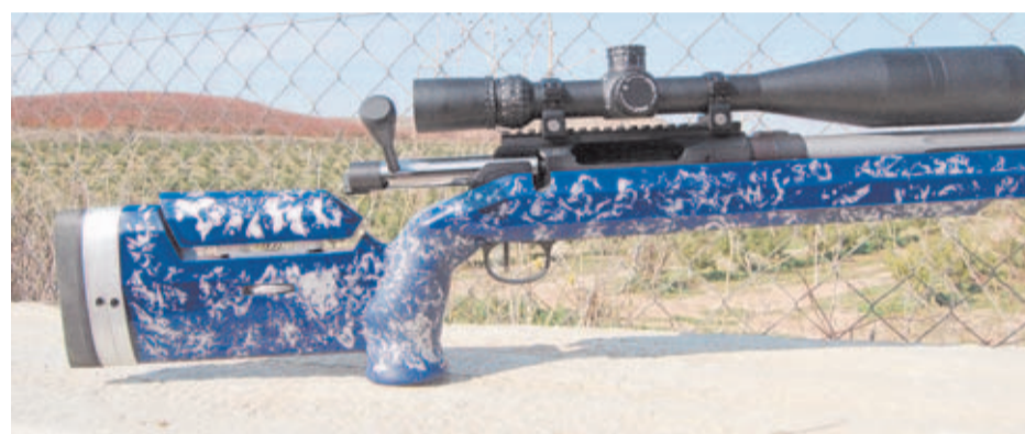
Detalle de la carrillera ajustable, la cantonera, y el cerrojo abierto de este rifle custom.
