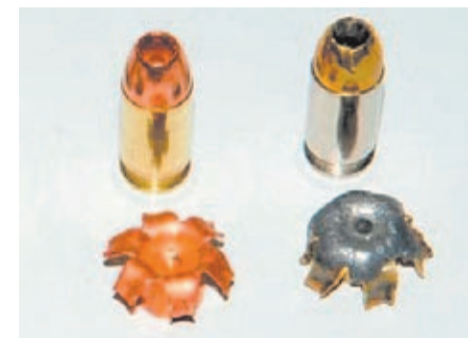
Puntas deformadas del calibre 9 Corto.
