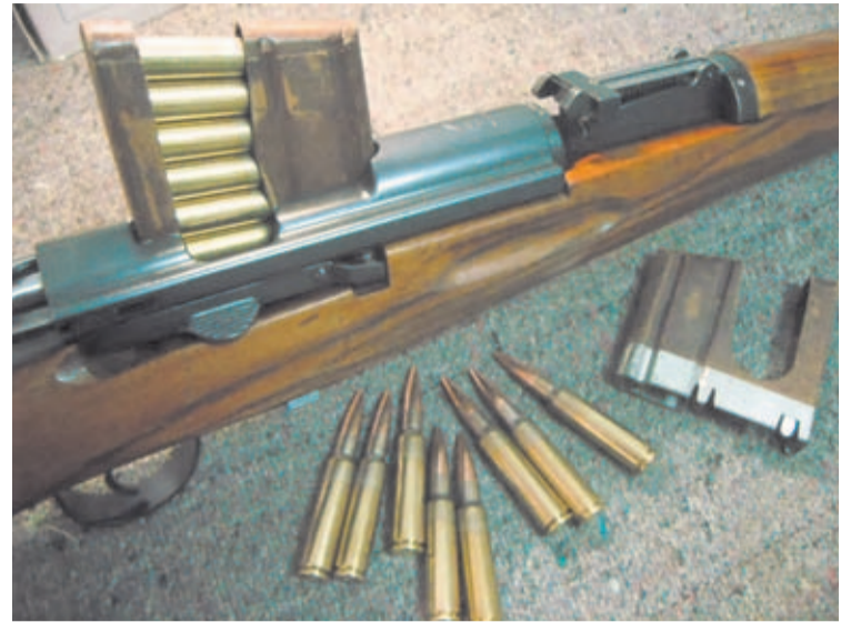
Alimentación del K-31 mediante un clip de cargado rápido.
