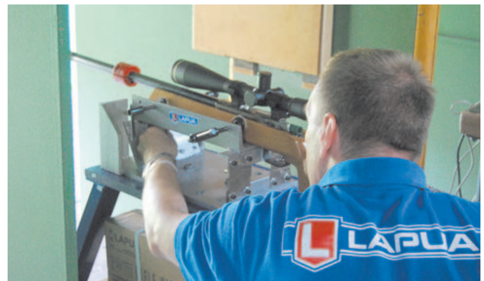
Un técnico del Service Center de Lapua ajustando el arma para el test de lotes de munición Lapua.
