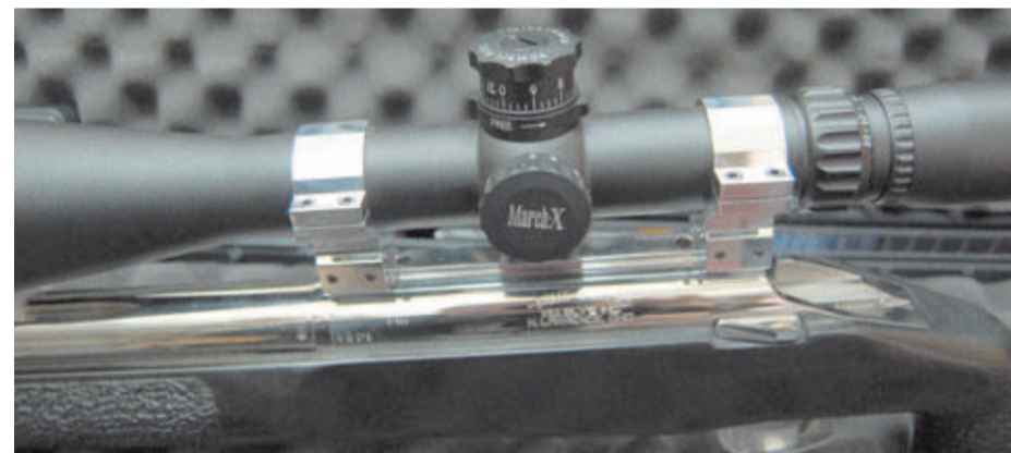
Detalle de las torretas tácticas de un Deon March-X 8-80x montado sobre un rifle Kelbly.
