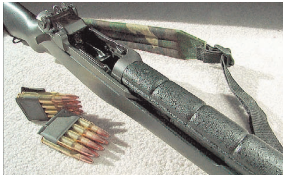
Peines con 8 cartuchos del calibre .30-06 junto con un M1 Garand con culata sintética.
