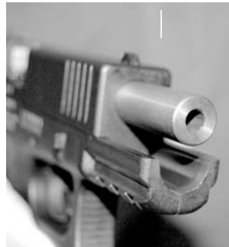
La pistola ISSC M22 cuenta con un cañón "bull barrel" pensado para la competición.
