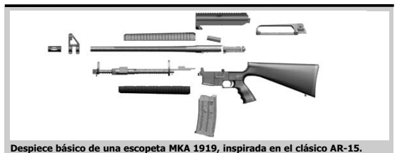
Despiece básico de una escopeta MKA 1919, inspirada en el clásico AR-15.
