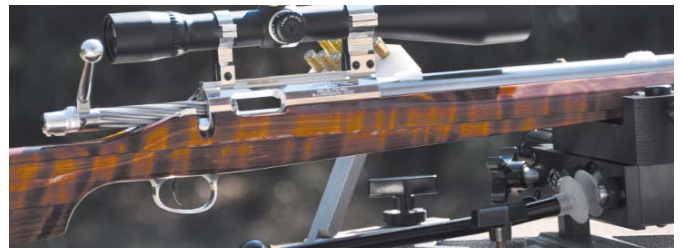
Conjunto básico para la alta precisión: rifle, mira óptica, saquete trasero y torreta de apoyo.
