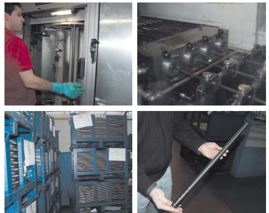
Estas cuatro fotografías recogen algunas de las fases más importantes del proceso de fabricación de los cañones Bergara. Sin duda, el taladrado, el bruñido, y sobre todo el estriado, son las que marcan la diferencia.
