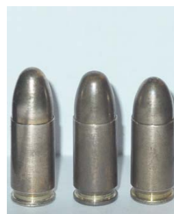
Elongación provocada en cartuchos del calibre 9mm Parabellum.
