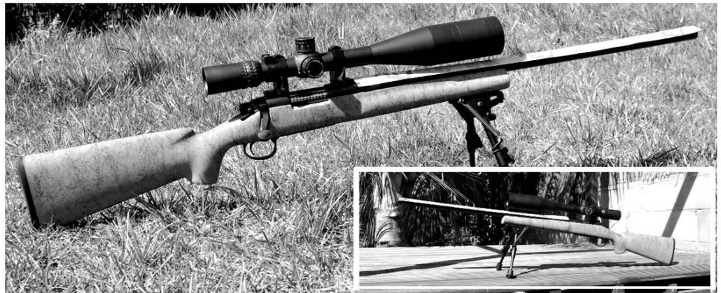
El Remington 700 VSF destaca por su culata sintética de color arena, la firmeza de su acción de cerrojo, y por su cañón flotante de diseño acanalado. Para completar esta excelente arma, recurrimos a un visor Nightforce NXS 12-42x56 y a un bípode Harris. / armas.es
