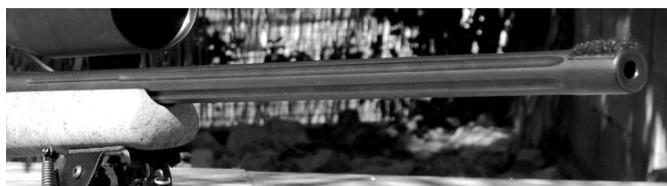
Un cañón pesado, acanalado y flotante aumenta la precisión del Remington 700 VSF / armas.es
