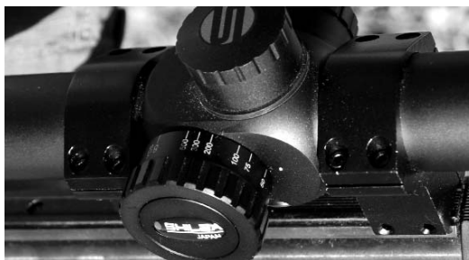
Este visor posee una torreta lateral para ajustes de paralaje. / armas.es
