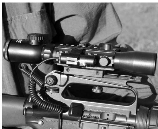
El modelo TRIAX se compone de un visor, una linterna y un puntero láser.
