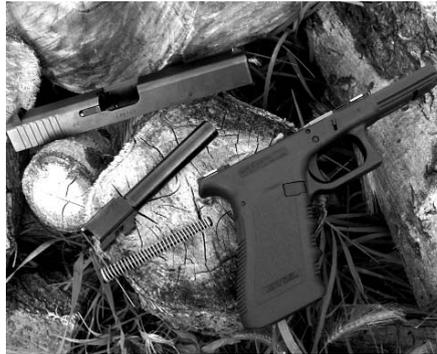
El despiece de la Glock 17 y del resto de modelos de la firma austriaca resulta muy sencillo. Son pocas piezas y fáciles de montar y desmontar.
