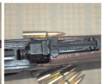
Detalle de las miras y la recámara del Tokarev.
