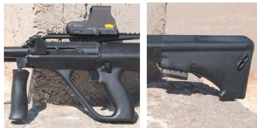
El Steyr AUG Z pesa 3,85 kg, dispone de un cañón de 51cm y de un rail táctico para incorporar una mira óptica. / armas.es
