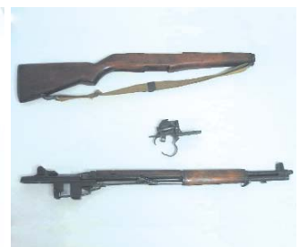
Despiece básico de este fusil semiautomático.
