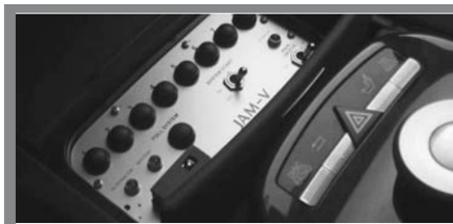
El control remoto del inhibidor GFB86 se instala junto al asiento del conductor, lo que permite al usuario tener un acceso directo al sistema y una ocultación total. Este dispositivo desarrollado por SESP Group también dispone de una función on/off para activar o desactivar cada banda de frecuencia individual.
