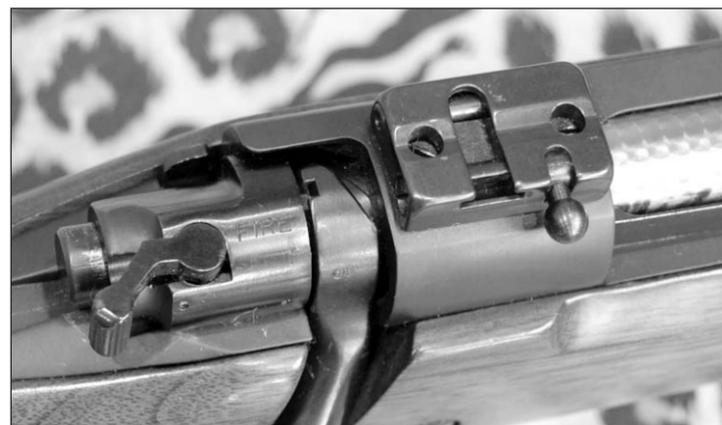
El doble anclaje ofrece una mayor robustez al rifle. Este refuerzo permite absorber buena parte del gran retroceso generado en los calibres para caza africana.
