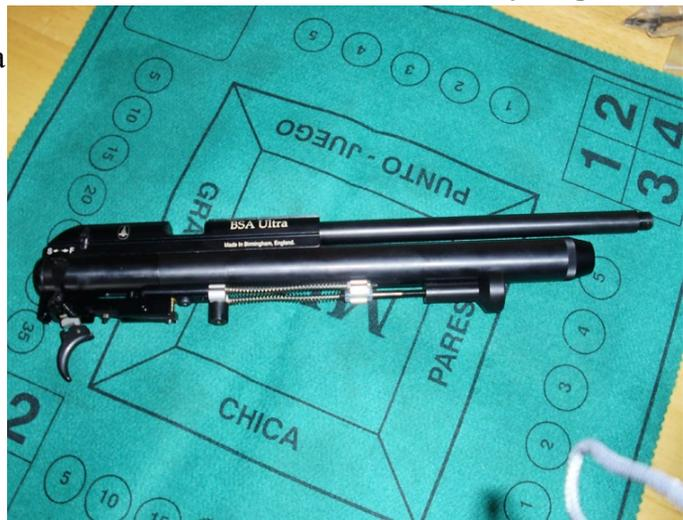
Puede verse en la siguiente fotografia el conjunto del arma, que sale tras aflojar y retirar un único tornillo allen.
