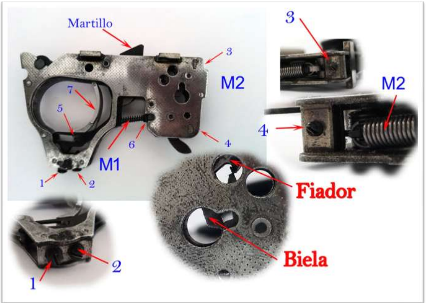
Figura 1.- Despiece del disparador ANTIGUO de la Walther GSP
