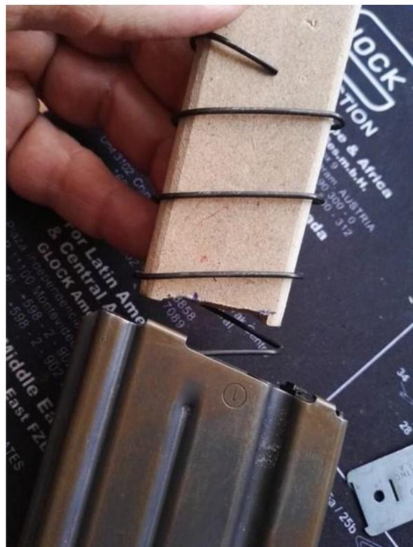
8º Empujamos con el dedo el muelle hasta que quede en su lugar y comprobamos como la madera queda al ras...Para ello he introducido los dos cartuchos en el cargador porque si no la madera quedaría metida dentro. Si la madera queda a su nivel está todo preparado.
