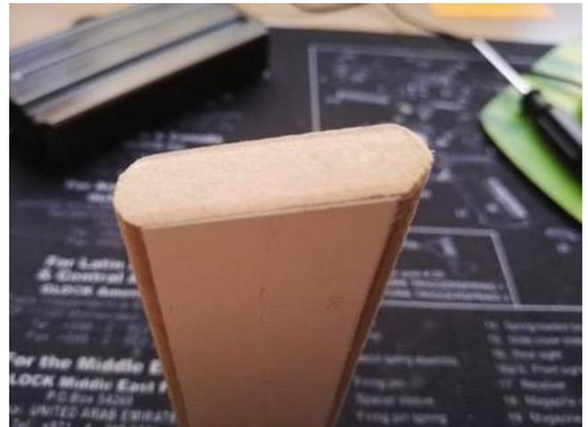
5º con la teja elevadora del cargador en la mano, hacemos una muesca en el extremo de la madera para que encaje el resalte de la teja que se ve en la imagen... (yo lo hice antes de cortar la madera pero es un error)
