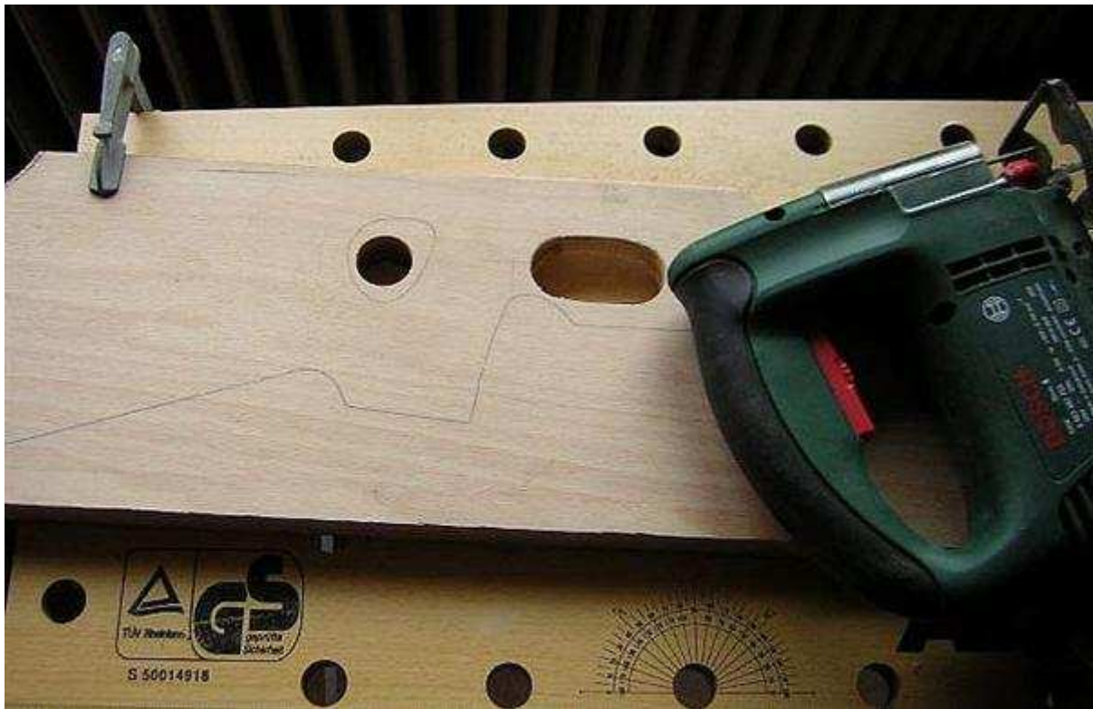
7. Hier die zwei Hälften des Schaftes nach dem Aussägen der Konturen. Zu erkennen sind auch die Ausfräsungen für das System sowie den Regulator und die Pressluftkartusche.
