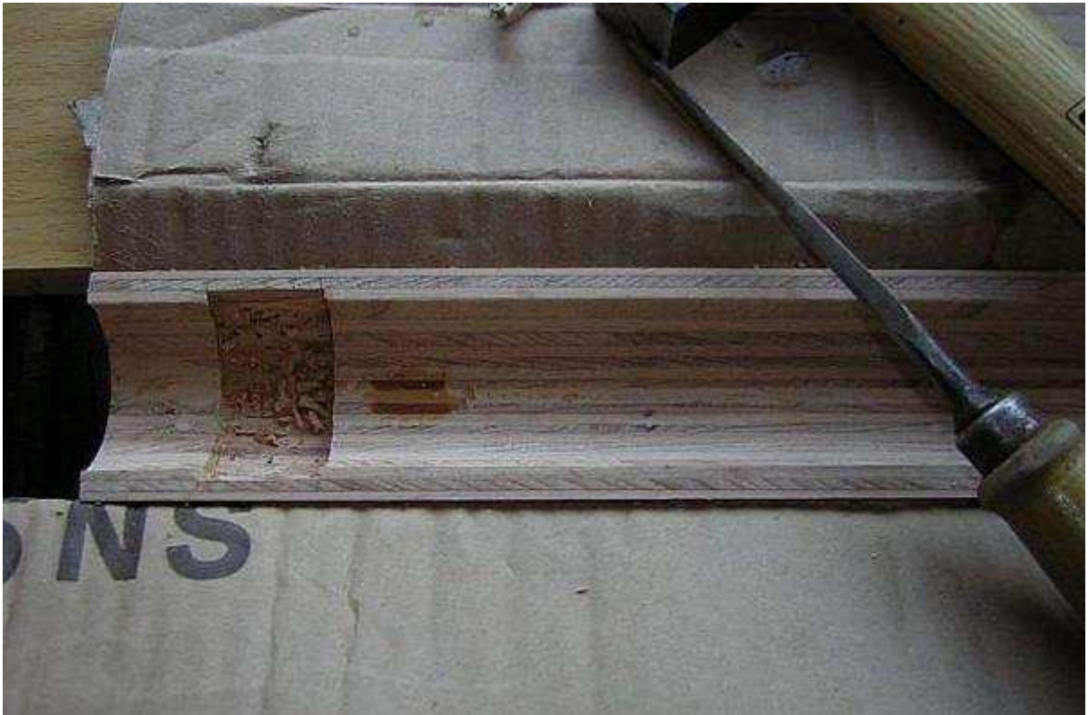
27. Nach einem weiteren Schliff mit Sandpapier Körnung 120 erfolgte der erste Test, ob das System auch spielfrei in den Schaft paßt. Erstmals zu sehen ist auf diesem Bild der Rohling für die Handstütze – ebenfalls aus 25 mm Buche-Multiplex hergestellt.
