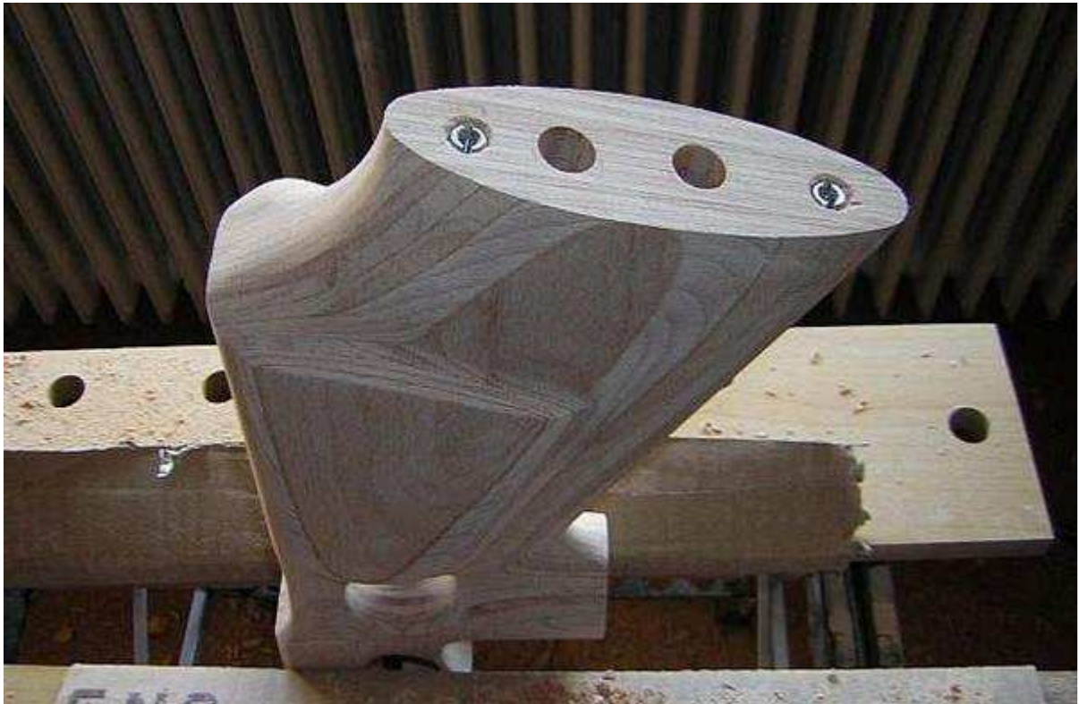
25. Nach der Anpassung des Schaftabschlusses (Schaftkappe) wurden auch hier zwei Rampa-Muffen (M5) eingedreht. Die zwei größeren Löcher haben einen Durchmesser von 13 mm und eine Tiefe von ca. 70 mm. Hier können bei Bedarf Gewichte untergebracht werden, um die Kopflastigkeit des Gewehrs auszugleichen. Da das LG 200 von mir mit der (größeren und schwereren) Pressluftkartusche des Dominators ausgestattet wurde, wird eine Gewichtsregulierung wohl erforderlich sein.
