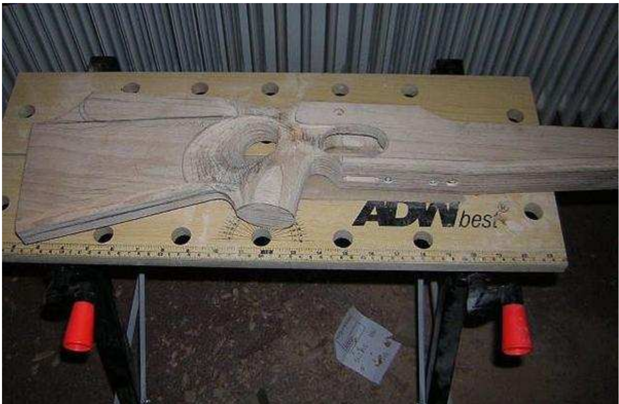
22. Das Loch für den Daumen und die Mulde für den Handballen mußten mehrfach nachgearbeitet werden, bis der richtige „Sitz“ (grob) gefunden war.
