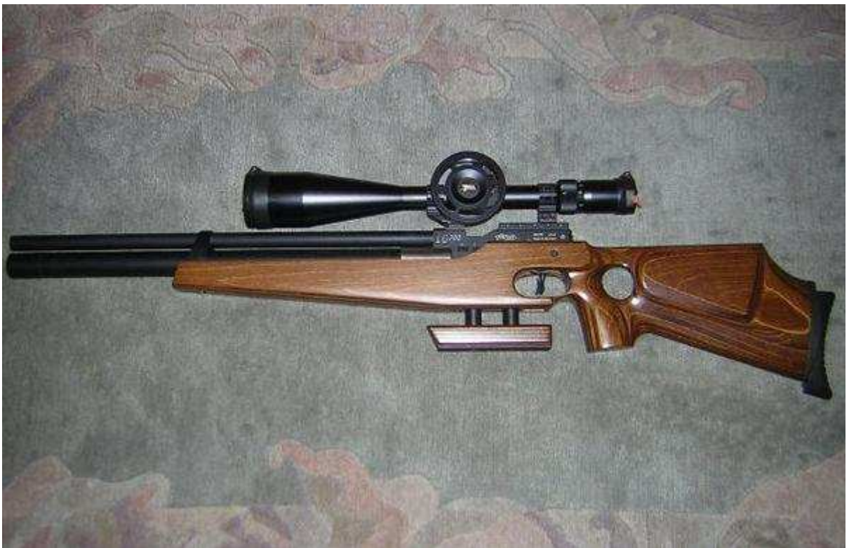
38. Abschließend das modifizierte LG 200 mit montiertem Zielfernrohr BSA 8-50x60:
