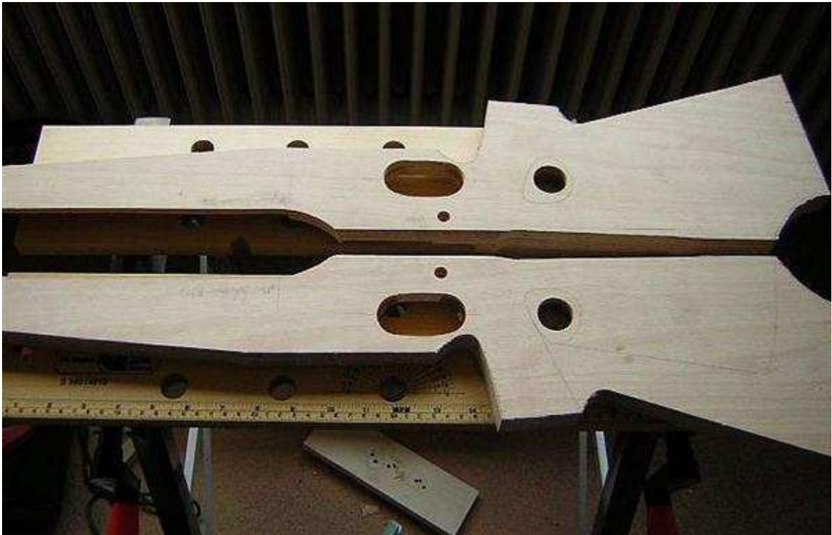
9. Nachdem die „Innereien“ komplett hergestellt (gefräst) waren, konnten nun die beiden Schafthälften dauerhaft mit Holzleim zu einem Schaftrohling verklebt werden.
