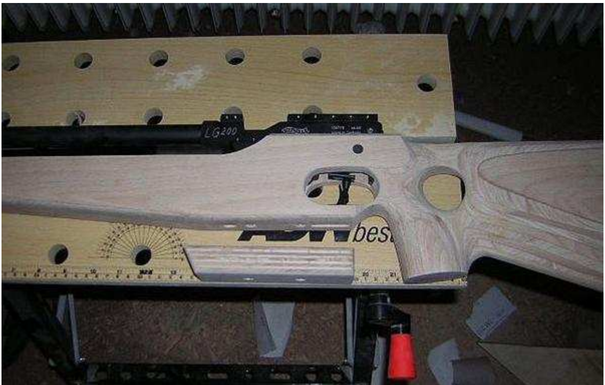
27. Nach einem weiteren Schliff mit Sandpapier Körnung 120 erfolgte der erste Test, ob das System auch spielfrei in den Schaft paßt. Erstmals zu sehen ist auf diesem Bild der Rohling für die Handstütze – ebenfalls aus 25 mm Buche-Multiplex hergestellt.
