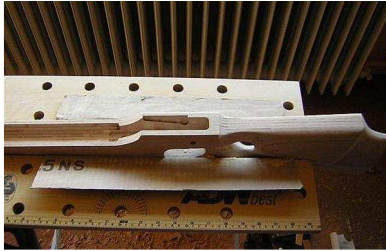
25. Nach der Anpassung des Schaftabschlusses (Schaftkappe) wurden auch hier zwei Rampa-Muffen (M5) eingedreht. Die zwei größeren Löcher haben einen Durchmesser von 13 mm und eine Tiefe von ca. 70 mm. Hier können bei Bedarf Gewichte untergebracht werden, um die Kopflastigkeit des Gewehrs auszugleichen. Da das LG 200 von mir mit der (größeren und schwereren) Pressluftkartusche des Dominators ausgestattet wurde, wird eine Gewichtsregulierung wohl erforderlich sein.
